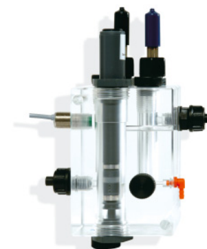
Portaelettrodo multiplo pH, RX, Sonda cloro potenziostatica, Sonda temperatura PT100 + sensore di prossimità Multiple electrode holder pH, RX (ORP), potentiostatic chlorine probe, PT100 temperature probe + proximity sensor
